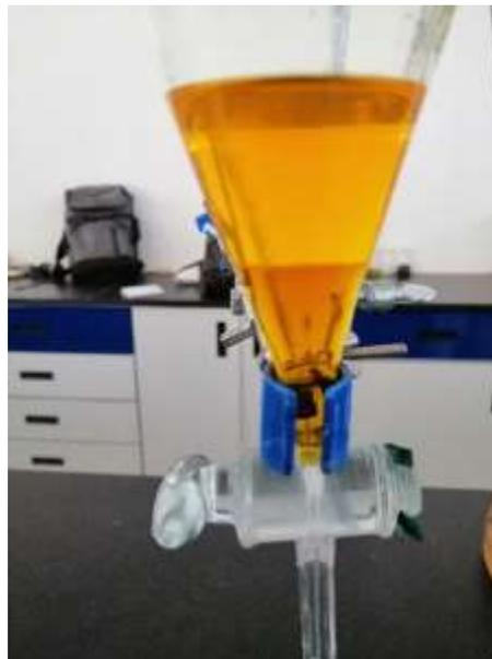
**Figura 22.** Separación de Jabones y biodiesel en el embudo de decantación cosecha 2019.
