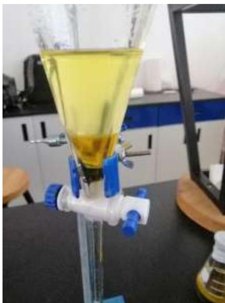
**Figura 23.** Separación de Jabones y biodiesel en el embudo de decantación semilla fresca 2020.
