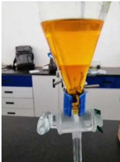
*Figura 20. Separación de prueba final de transesterificación.*
